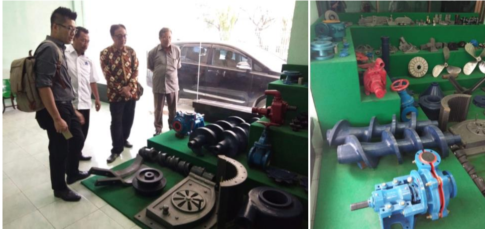
Gambar 8. Concrete Mixer Blade yang terbuat dari Ni-Hard untuk substitusi Impor
