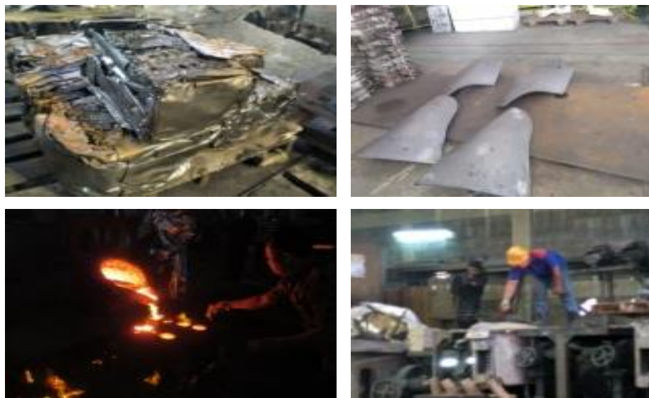
Gambar 3.14. Proses Pembuatan Mass Concrete Blade dari White cast iron
